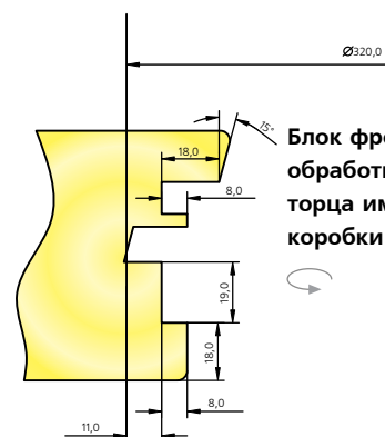
Блок фрез для обработки верхнего и бокового торца импоста коробки
